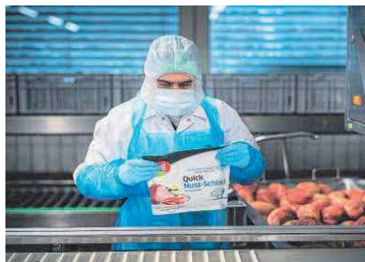
Viele Arbeitsschritte führen zum Schinkli: impfen, im Tumbler massieren, aus dem Netz nehmen, verpacken, pasteurisieren.
