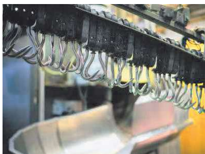
Rohrbahnen transportieren die schweren Körper.
