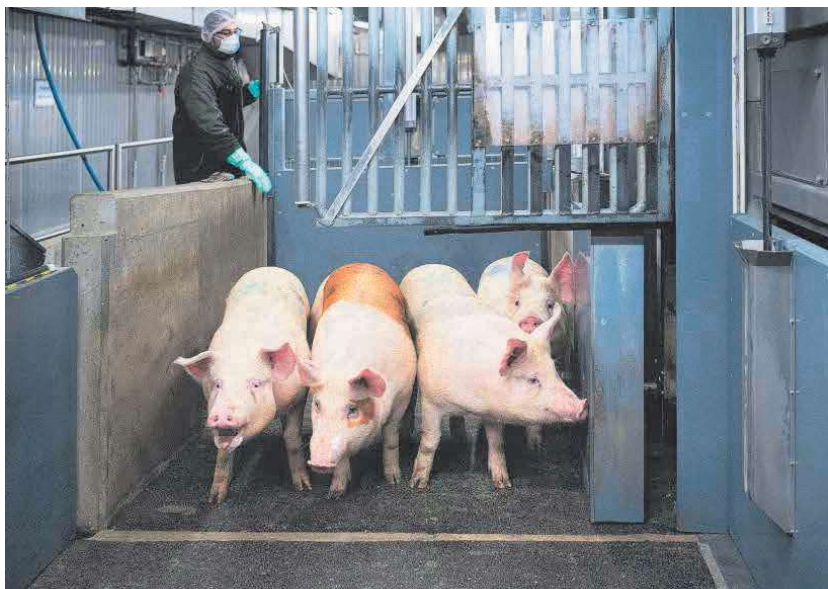
Der Gang zur Betäubungsanlage steigt an, weil Schweine wie Saueli lieber aufwärts gehen.
